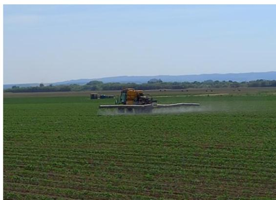
**Figura 9** - Pulverizador automotriz
