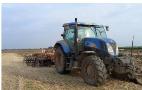
**Figura 6** - Trator com grade de discos Galucho
