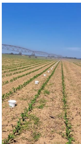
Figura 21 - Ensaio de uniformidade de rega em pivô
