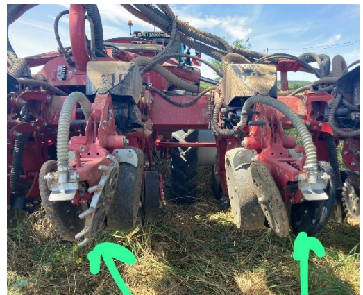
Figura 15 - Rodas de compressão do semeador
