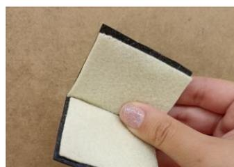
**Figura 54** - Interior da ligação da cortiça ao feltro (Fonte: Autor)
