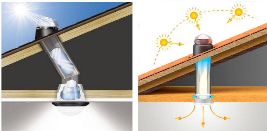
Figura 73 - Tubo Solar, fonte Tecnalbi
