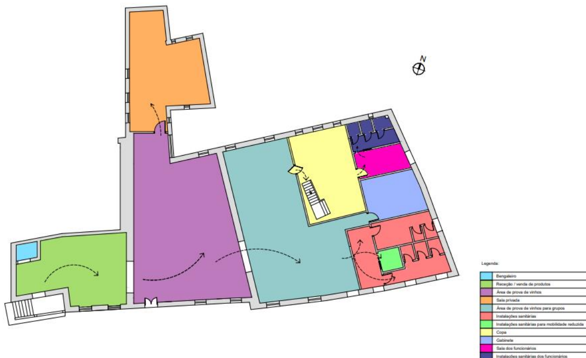
Figura 68 - Planta de zonamento e circulação
