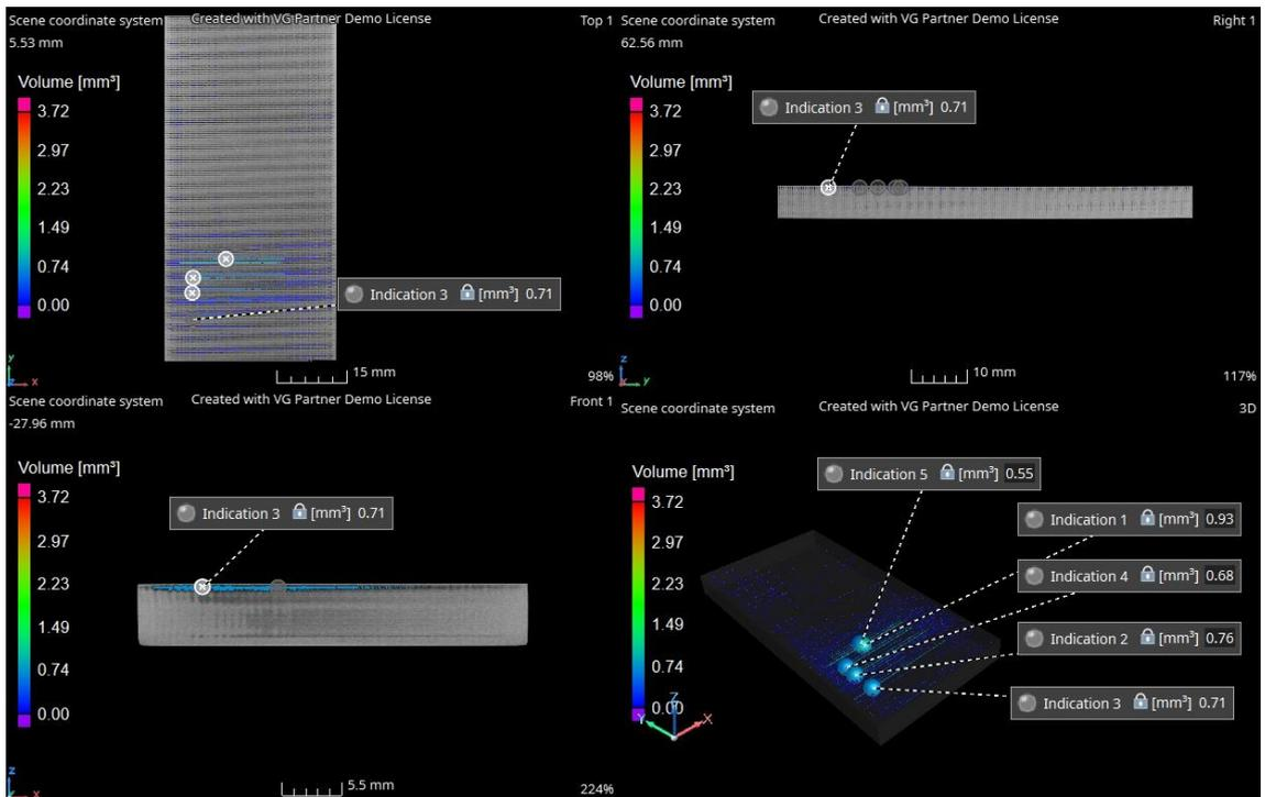
Figura 23: Porosidade do provete de 90 graus
