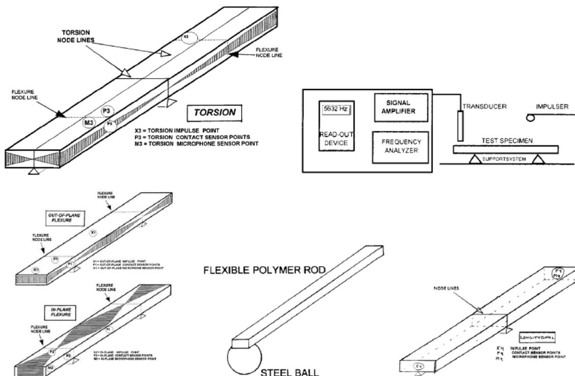
Figura 1: metodologia dos ensaios pela Norma [1]
