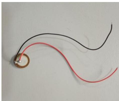
Figura 10: Acelerómetro piezoeléctrico
