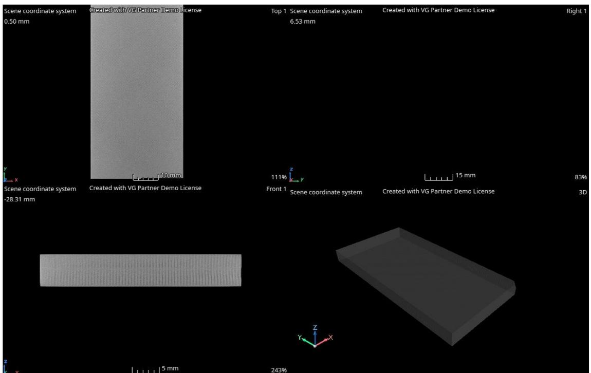
Figura 24: Porosidade do provete de 45 graus
