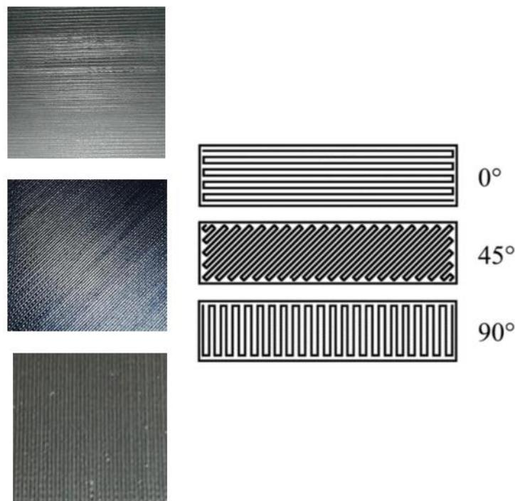
Figura 9: fotos parciais dos provetes e o seu ângulo de impressão [5].
