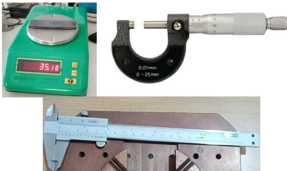
Figura 12: Balança digital, paquímetro e micrómetro utilizados.
