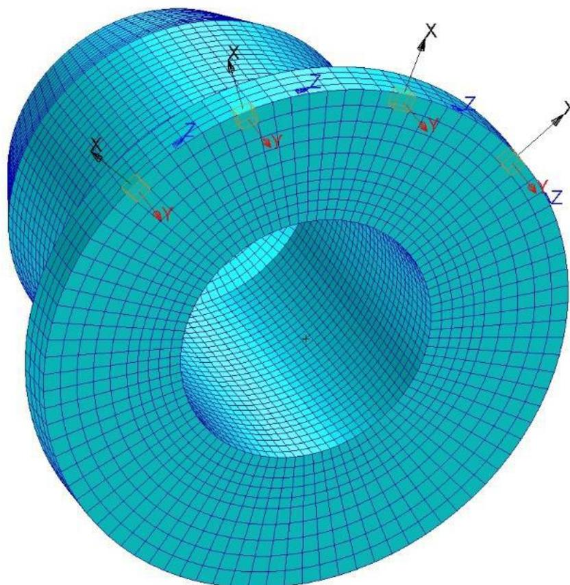
Figura 32: Malha do modelo anisotrópico com sistemas de coordenadas locais dos elementos.
