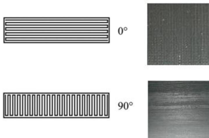
Figura 8: Representação da impressão dos provetes transversais 0.10mm.
