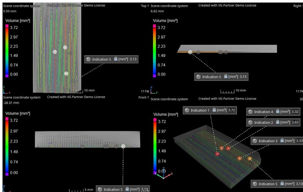
Figura 22: Porosidade do provete de 0 Graus.
