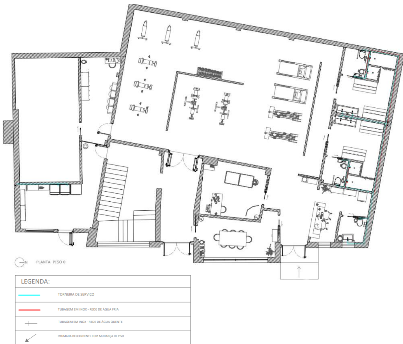
Figura 145- Planta de Rede de Água, Fonte: Autor
