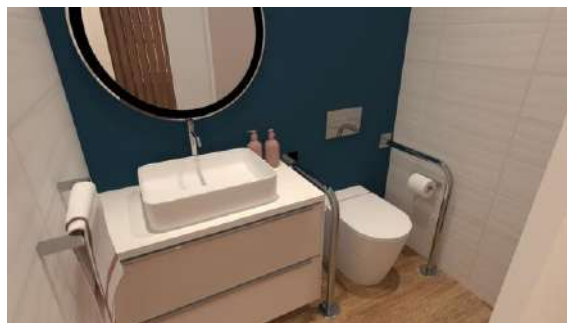
Figura 37 - WC com Apoios
