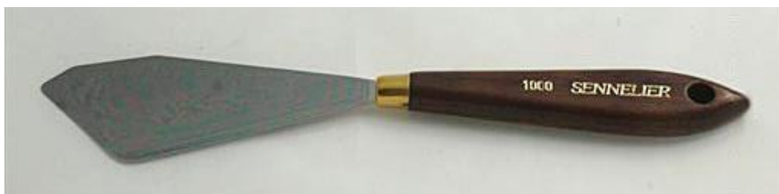
Figura 52 - Nº1000, C=210mm, L (d/lâmina) =40mm. Fonte: Autor
