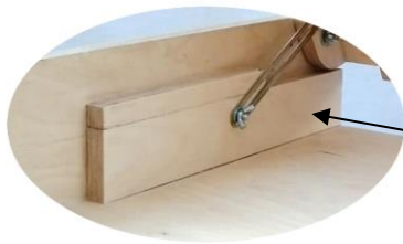
Figura 72 - Peça onde o cavalete se apoia enquanto está em uso ou não, sob a forma de protótipo final. Fonte: Autor
