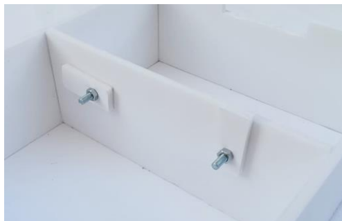
Figura 68 - Maquete de batentes de madeira amovíveis, com parafuso e porca. Fonte: Autor
