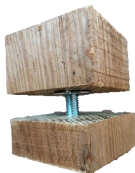
Figura 63 - Modelo experimental de pé nivelador de madeira. Fonte: Autor
