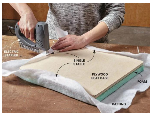
Imagem 62 – Agrafar o material de enchimento; Family Handy Man, https://www.familyhandyman.com/project/how-to-reupholster-a-chair/ consultado a 7 de junho de 2021
