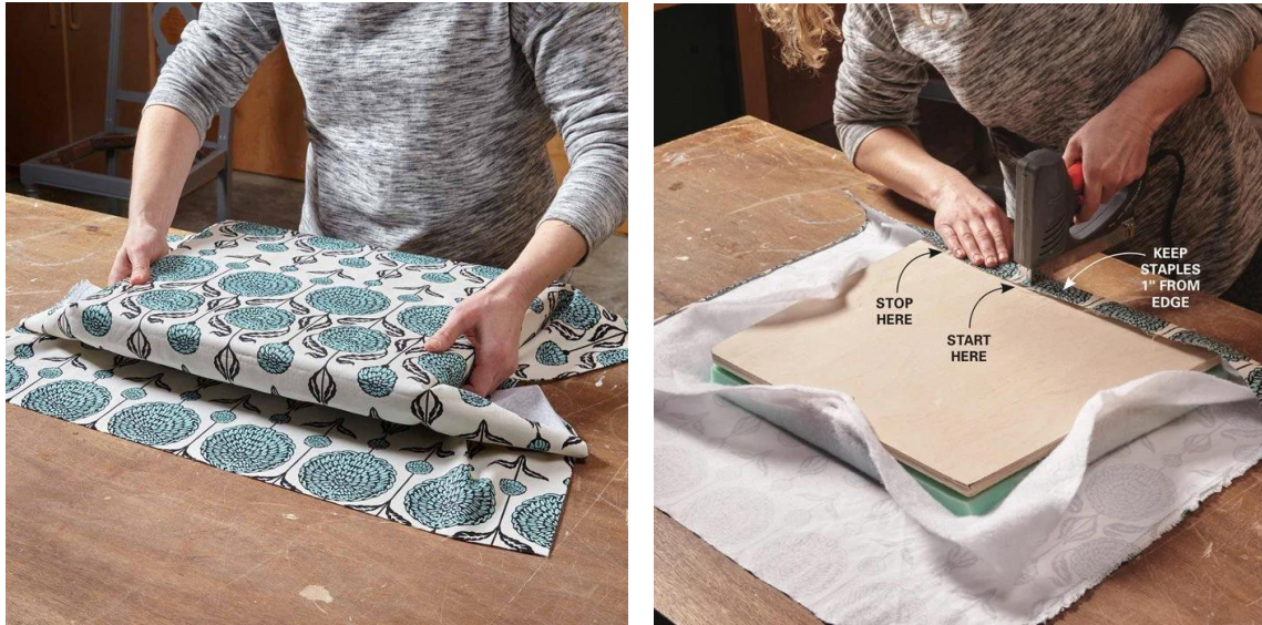
Imagem 63 e 64 – Como agrafar o revestimento; Family Handy Man, https://www.familyhandyman.com/project/how-to-reupholster-a-chair/ consultado a 7 de junho de 2021
