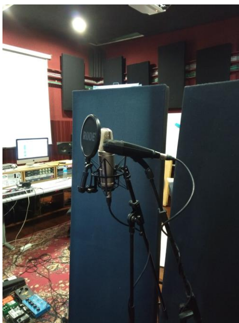
Figura 9 – Posicionamento dos microfones na gravação de trompetes
