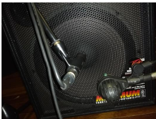
Figura 7 – Posicionamento dos microfones na gravação de baixos
