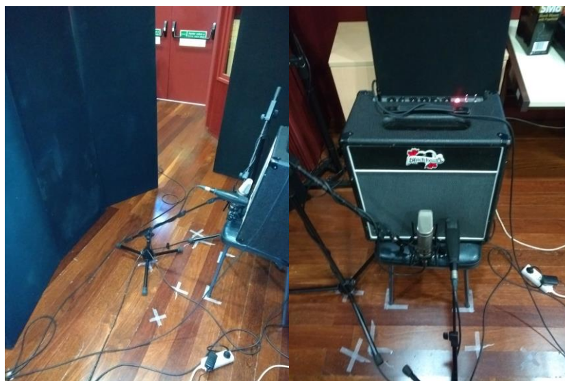
Figura 8.1 e 8.2 – Posicionamento dos microfones na gravação de guitarras
