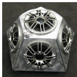
FIGURA 5- ALTIFALANTE HEMISFÉRICO MULTICANAL DESENVOLVIDO POR A ORCHESTRA DE LAPTOP'S DE PRINCETON.
