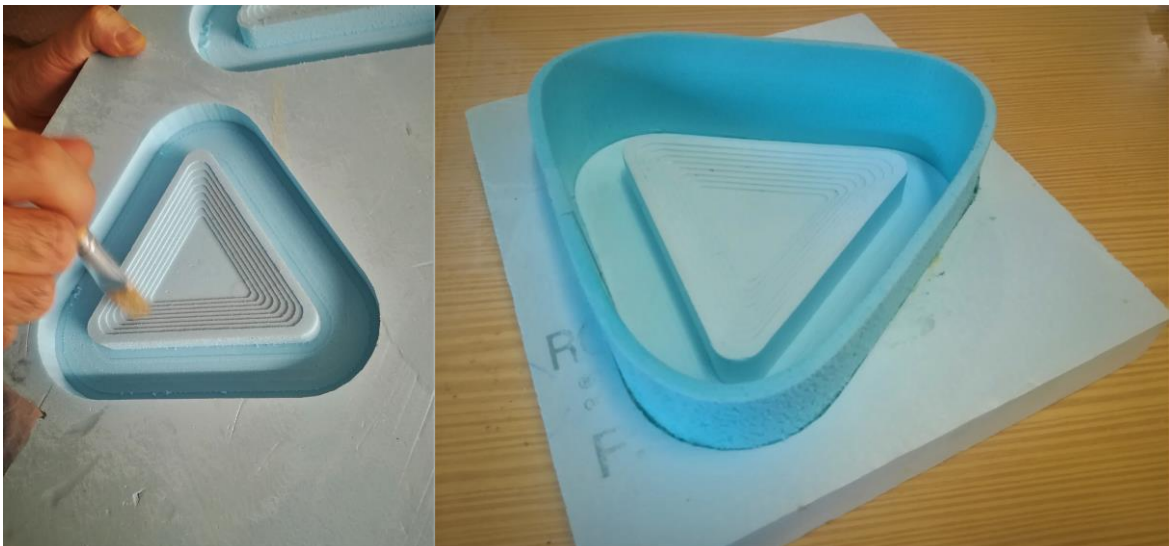
Figura 13- Molde em poliestireno finalizado, banhado com vaselina
