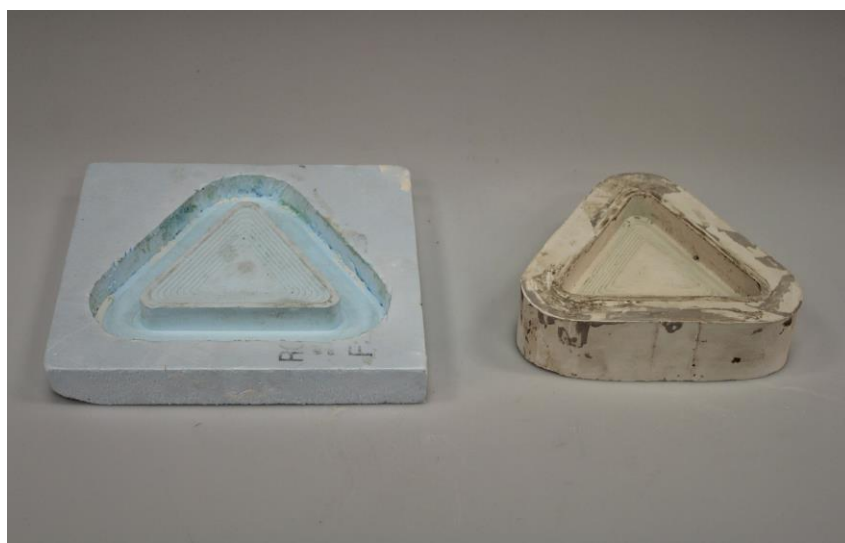
Figura 9 - Molde em poliestireno e a sua impressão em gesso
