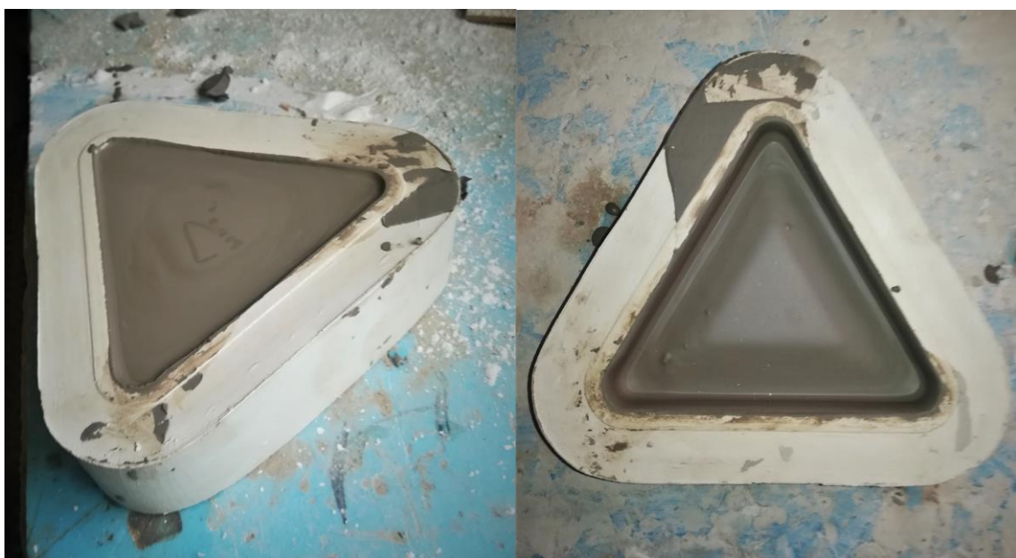
Figura 15- Molde em gesso com barbotina
