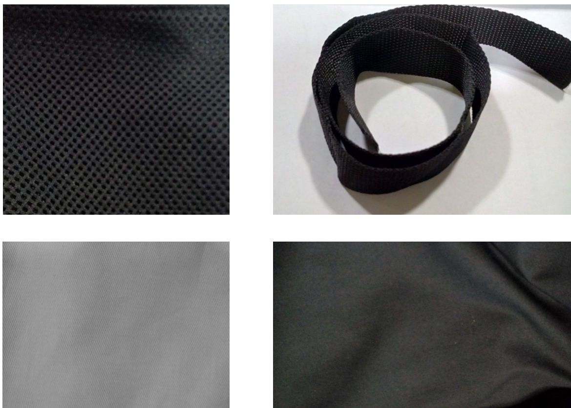
Figura 13 - Rede "sport", percinta, sarja e cambraia, da esquerda para a direita, de cima para baixo
