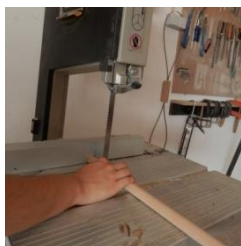
Imagem 18- Corte das cavilhas na Serra de Fita.
