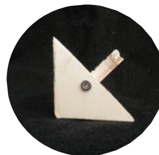
Imagem 28- Exemplo de encaixe com parafuso philips.
