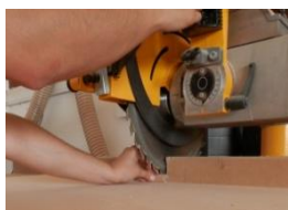
Imagem 19- Rebaixos das cavilhas com Serra Circular.
