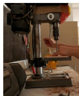
Imagem 22- Furos com Engenho de Furar.
