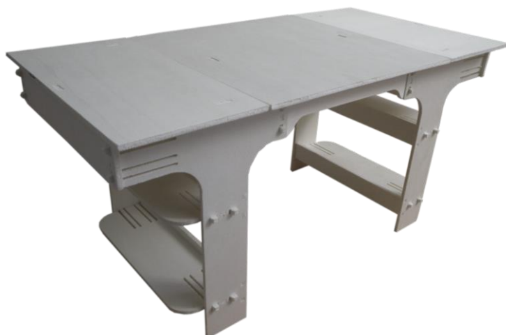
Figura 36. Maqueta da mesa realizada em CNC.
