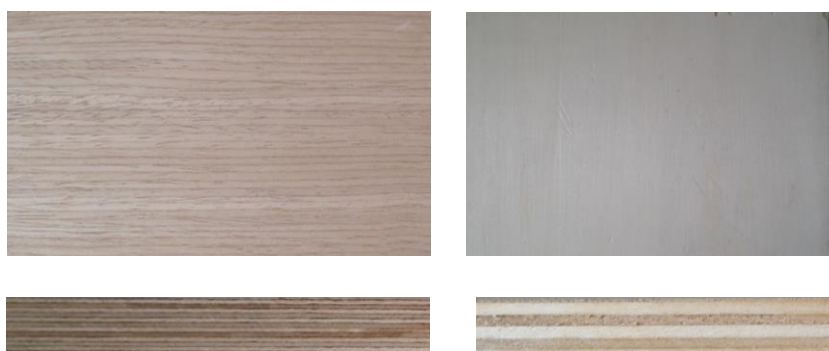
Figura 25. Contraplacado de carvalho e contraplacado de chopo
