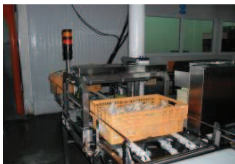
Figura 3: Pesagem e etiquetagem automática dos frangos em caixas de PVC.
