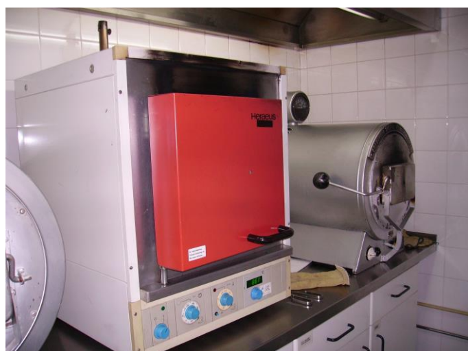
Fotografia 10.1 Mufla para a determinação das cinzas
