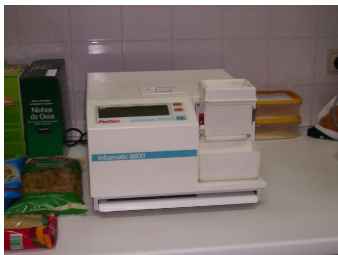
Fotografia 10 Inframatic 8600, para a determinação das cinzas
