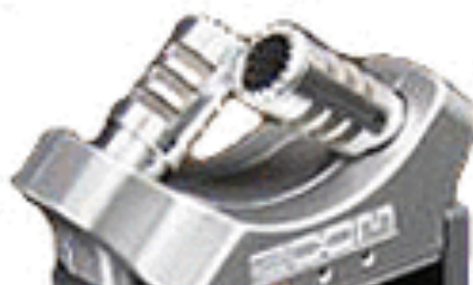
Fig. 12 – Representação da técnica de captação XY (Zoom H4n)
